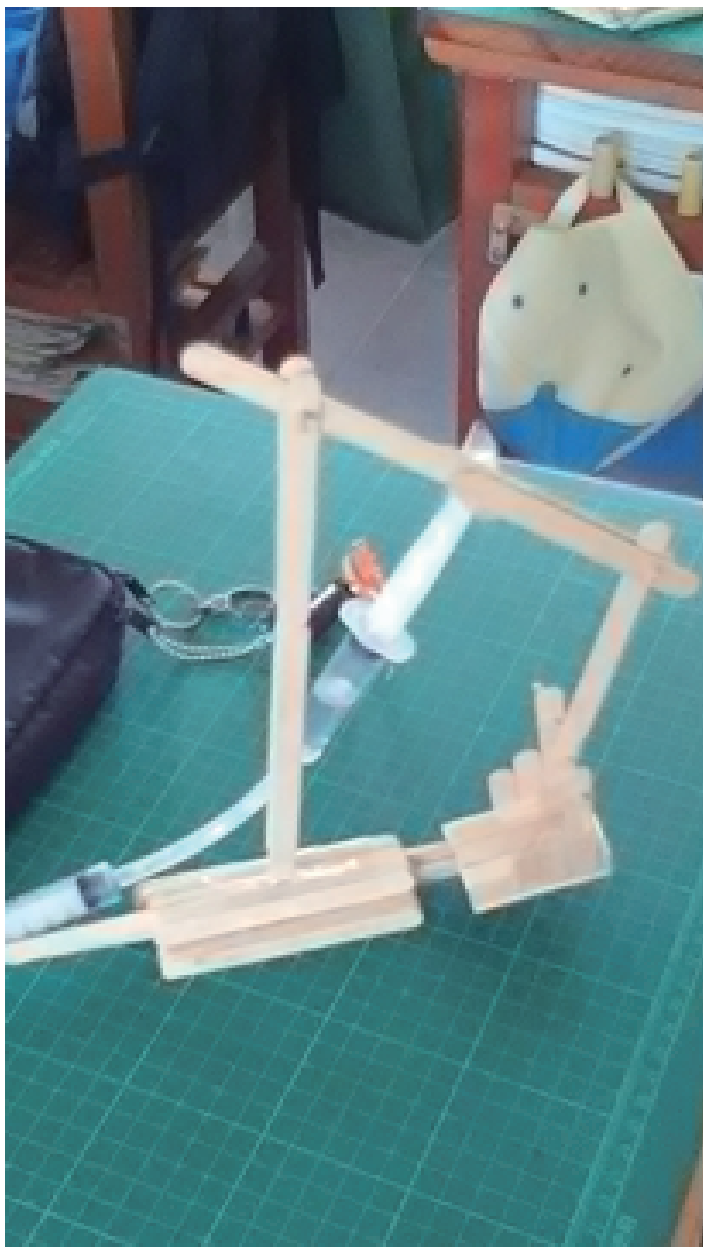
/ 學生實作液壓式挖土機模型作品
